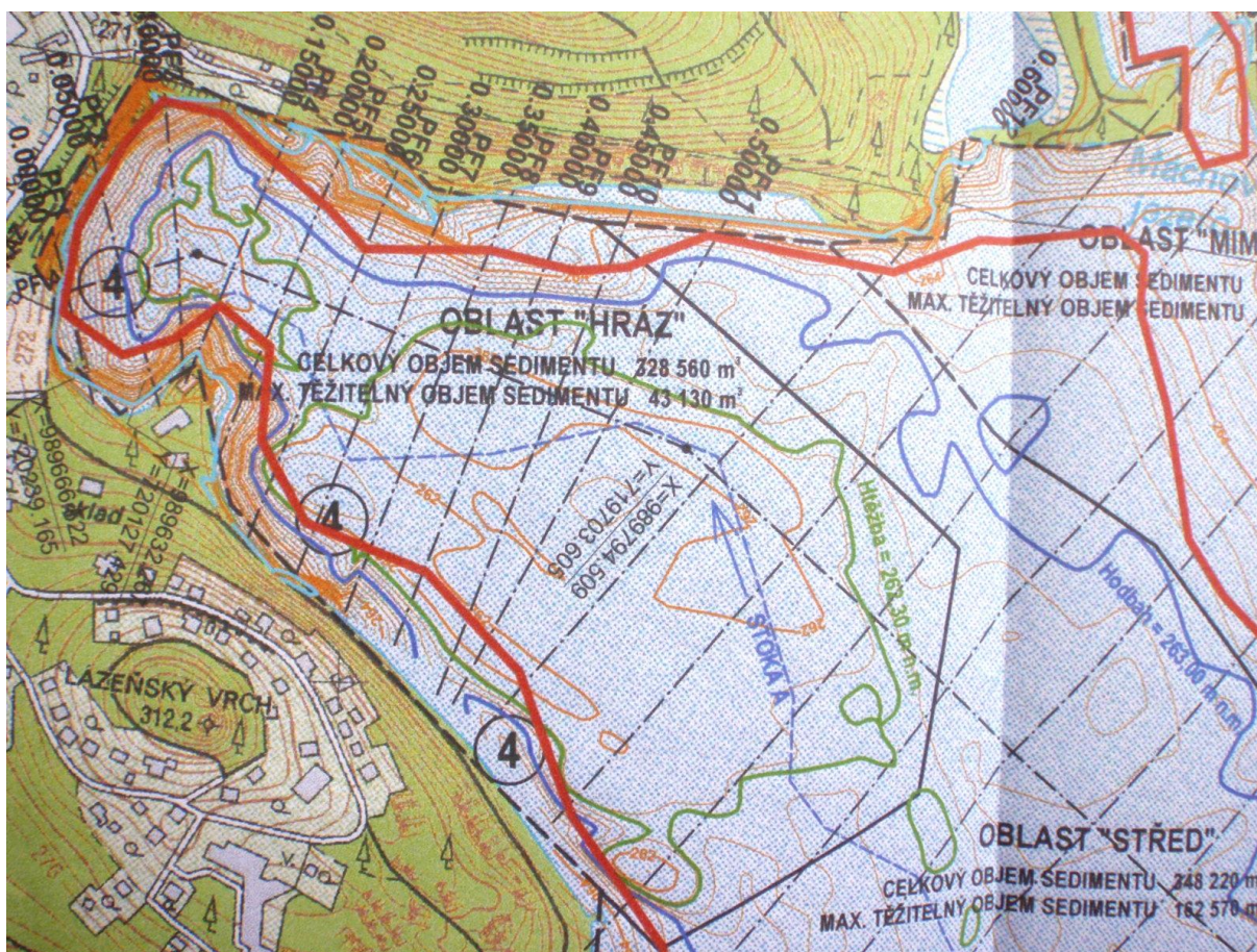
Obr. 2: Máchovo jezero, oblast hráze – izočáry povrchu dna dle zaměření TBD v roce 2005. Zhruba v trase příčného profilu PF6-PF7 lze pozorovat mírné vyvýšení dna, které odděluje cca 30 ha obtížně slovitelnou prohlubeň (kontura zelenou vrstevnicí). Mapa převzata [7].
