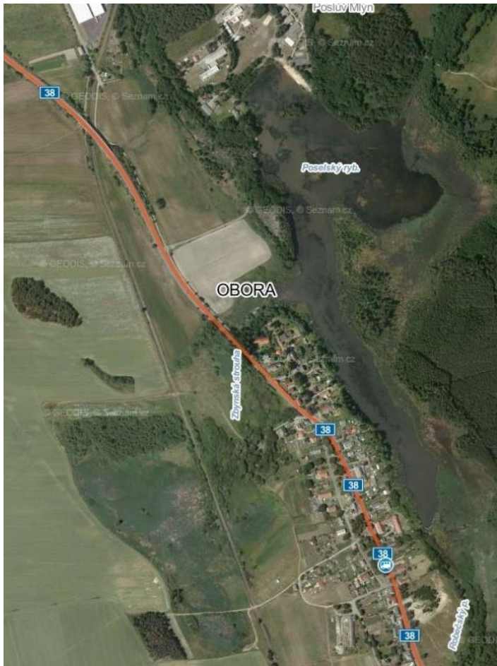
Obr. 23: Poselský rybník, ortofoto cca r. 2009 (zdroj: Mapy.cz). Na obrázku jsou vidět rozsáhlé porosty vodních rostlin, které v posledních letech ustoupily. Na ortofotomapě je zachycena situace po srážko-odtokové události, kde je dobře vidět, že z pravého břehu přitekla voda bez erozního materiálu, zatímco jak přítokem, tak z levé strany v místě nápisu OBORA přitekla voda zakalená.
