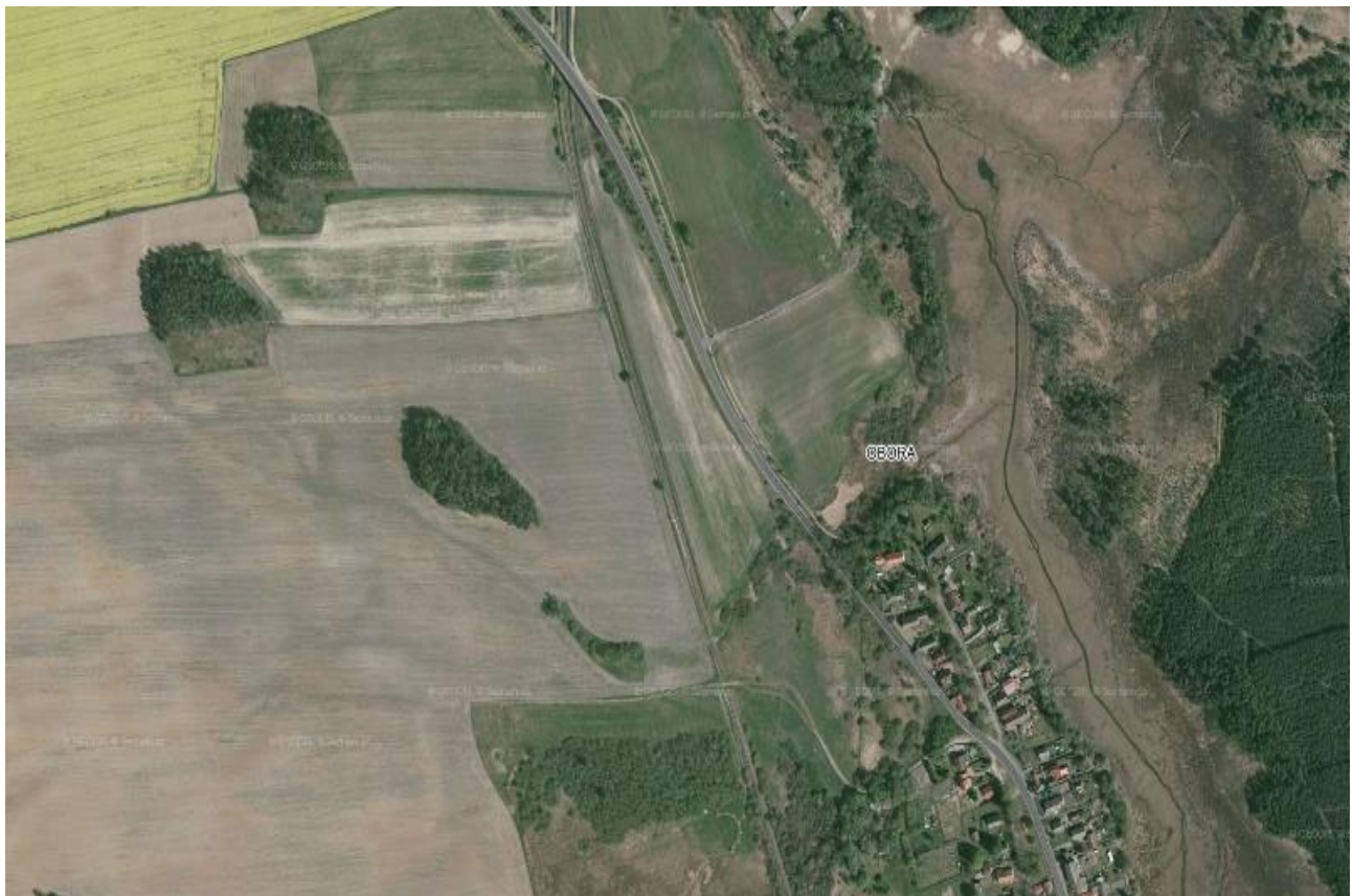
Obr. 24: Poselský rybník, ortofoto rok 2006 (zdroj: Mapy.cz). Na obrázku je na dně vypuštěného rybníka vidět strouha z levého břehu na severním okraji obce Obora. Zároveň jsou na tomto snímku velmi dobře patrné dráhy soustředěného odtoku, které podcházejí žel. trať, silnici a ústí až do Poselského rybníka. Jedná se o inspiraci na téma protierozní opatření, které má výrazně omezit množství erozního materiálu pronikajícího do Poselského rybníka. Rybník se postupně zazemňuje a ztrácí schopnost nejen retence vody, ale také fosforu, klíčové živiny.
